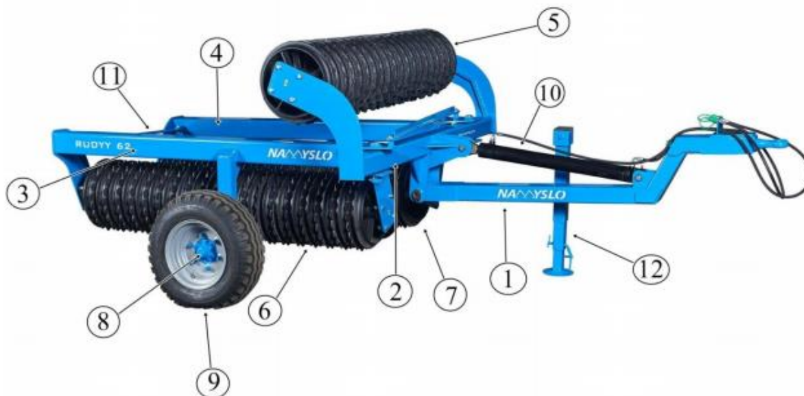
Rys.1 Wał uprawowy RUDYY - z górnym zaczepem transportowym 1- dyszel; 2 – rama środkowa; 3 – rama boczna prawa; 4 – rama boczna lewa; 5 – piasta koła; 6 – koło jezdne; 7 – wał środkowy; 8 – wał boczny prawy; 9 – wał boczny lewy; 10 – ciągnio transportowe; 11 – cylinder hydrauliczny; 12 – stopka podporowa;
